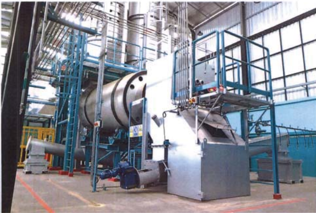
ห้องเผาหลักแบบหมุน (Kiln Chamber)
