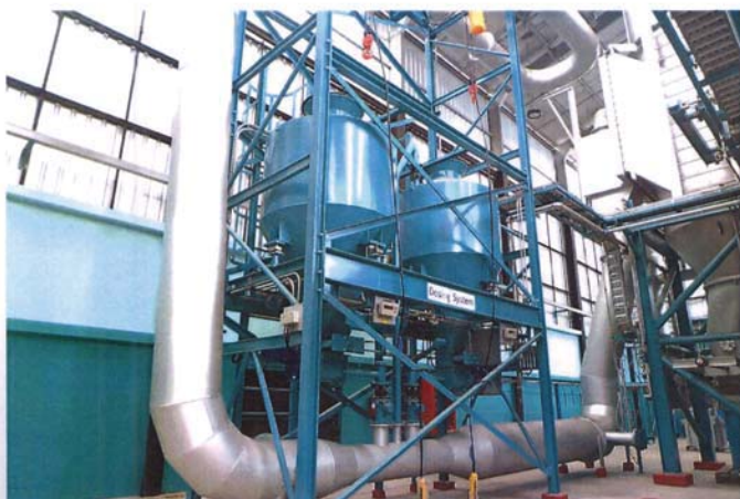
ระบบบำบัดก๊าซแบบแห้ง (Dry Scrubbing System)
